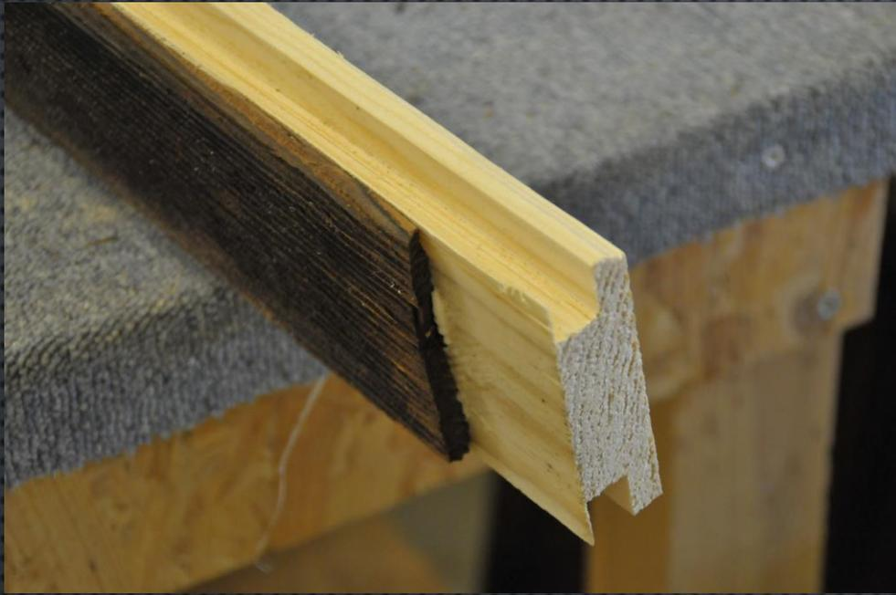
Ausarbeiten der Zapfenkonstruktionen an den aufgedoppelten Rahmenhölzern.
